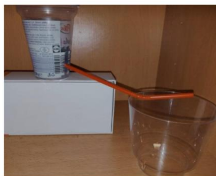
Obr. č. 1- Improvizovaná piesková filtračná aparátúra
