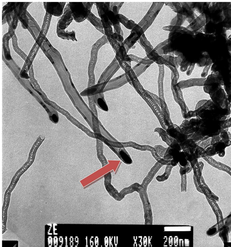
Obr. 4 Častice Fe katalyzátora na konci uhlíkových nanorúrok. (Snímka uhlíkových nanorúrok narastených na Fe-zeolite. Na koncoch viacvrstvových nanorúrok sú častice katalyzátora. Častice katalyzátora sú uzavreté vnútri nanorúrky. Snímka z transmisného elektrónového mikroskopu.)
