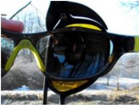
Obr. 5 Dva polarizačné sklá uložené tak, že neprepúšťajú ani horizontálne ani vertikálne svetelné vlnenie
