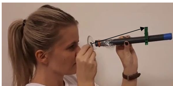
Obr. 16 Meranie otočenia roviny polarizovaného svetla
