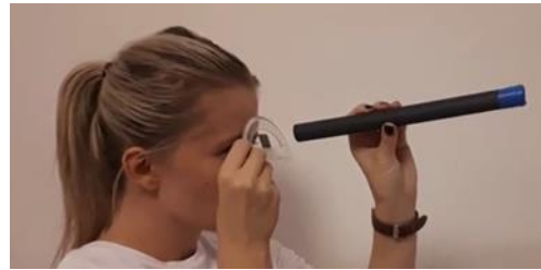
Obr. 10 Príprava polarimetra – nastavenie polarizátora a analyzátor
