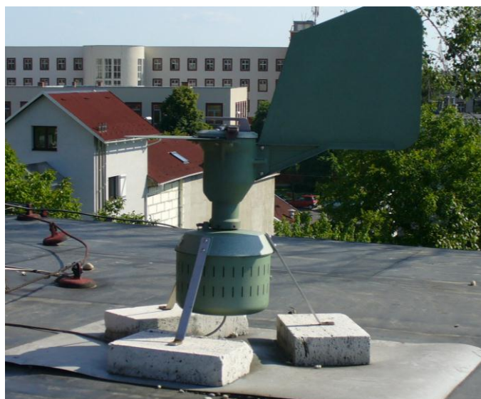
Obr. 1 Lapač peľu – typ Burkard, inštalovaný na streche budovy Katedry botaniky Univerzity Komenského v Bratislave, foto: K. Stašová
