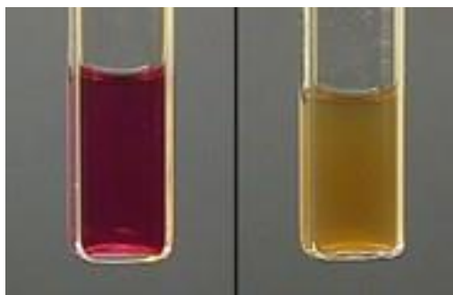
Obr. 3 Dôkazová reakcia butánu (bez zmeny farby) a acetylénu (odfarbené alebo hnedasté zafarbenie) s roztokom \text{KMnO}_4
