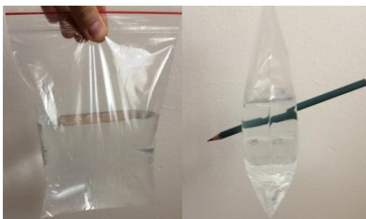
Obr. 1 LDPE vrečko naplnené vodou a následne prepichnuté ceruzkou
