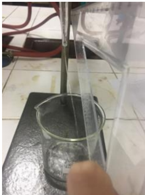
Obr. 2 Nevychýlenie prúdu lekárskeho benzínu po priložení zelektrozovaného pravítka
