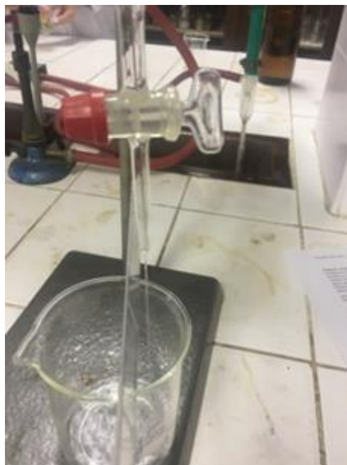
Obr. 2 Nevychýlenie prúdu lekárskeho benzínu po priložení zelektrozovaného pravítka
