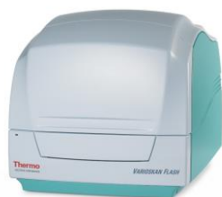
Obr. 1. Varioskan Flash – multifunkčný mikroplatničkový snímač so spektrálnym skenovaním
